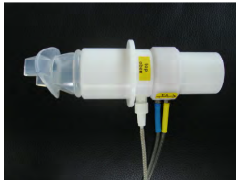
Zusammengebauter Ergo Flow Sensor mit Adapter und Mundstück
